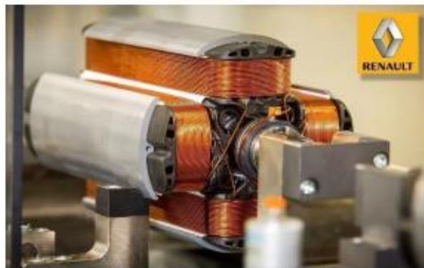
Слика 10 – Синхрони мотор са намотаним ротором – Изглед ротора са побудним намотајима повезаним са клизним прстеновима, [21].
