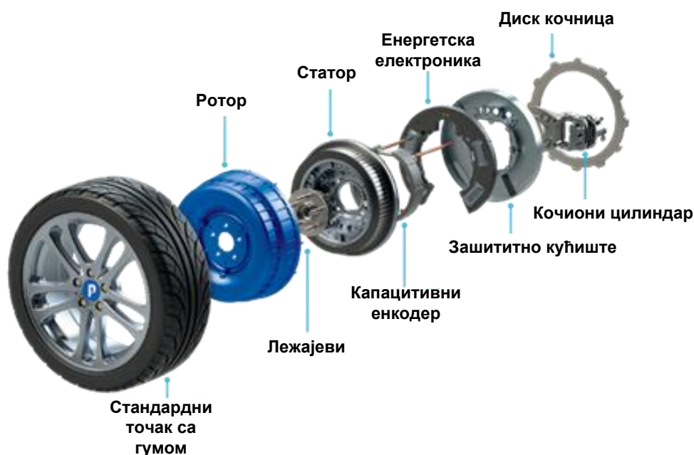
Слика 12 - Дијаграм који приказује компоненте електричног мотора у точку. ПД18 укључује енергетску електронику и диск кочницу за замену OEM (Original Equipment Manufacturers) кочнице, чинећи паковање много једноставнијим, [26]
