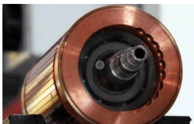
Слика 6 – Ротор Теслин-ог електричног мотора у јуну 2007.године, [15]
