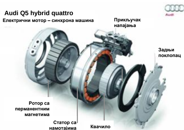
Слика 3 - Синхрони мотором са површинским перманентним магнетом (СМПМ) на хибридном аутомобилу Audi Q5 хибрид кватро, [9]
