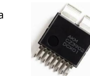
Meri struju koja prolazi kroz elektromotor, bez obzira na tip motora (DC, AC, asinhroni, sinkroni itd.). Ovaj senzor je ključan za pravilno upravljanje motorom, jer omogućava nadzor struje u realnom vremenu i pomaže u optimizaciji performansi motora.
