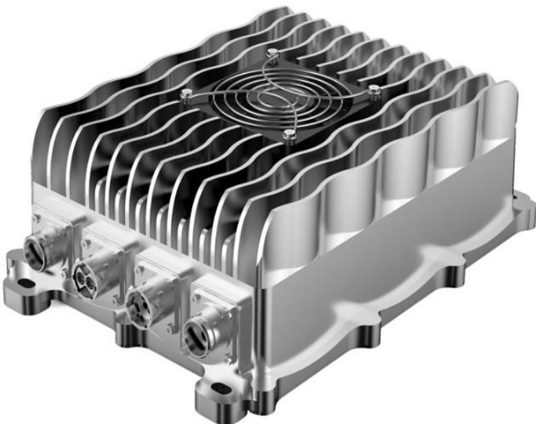
Potpuno električna i mnoga hibridno-električna vozila ne koriste konvencionalni alternator za punjenje 12-voltne baterije. Umjesto toga, ova vozila koriste DC-DC konvertor za podizanje visokog napona iz akumulatora na niskonapon, dopunjujući niskonaponsku bateriju i snabdjevajući električnom energijom za druge niskonaponske funkcije.
